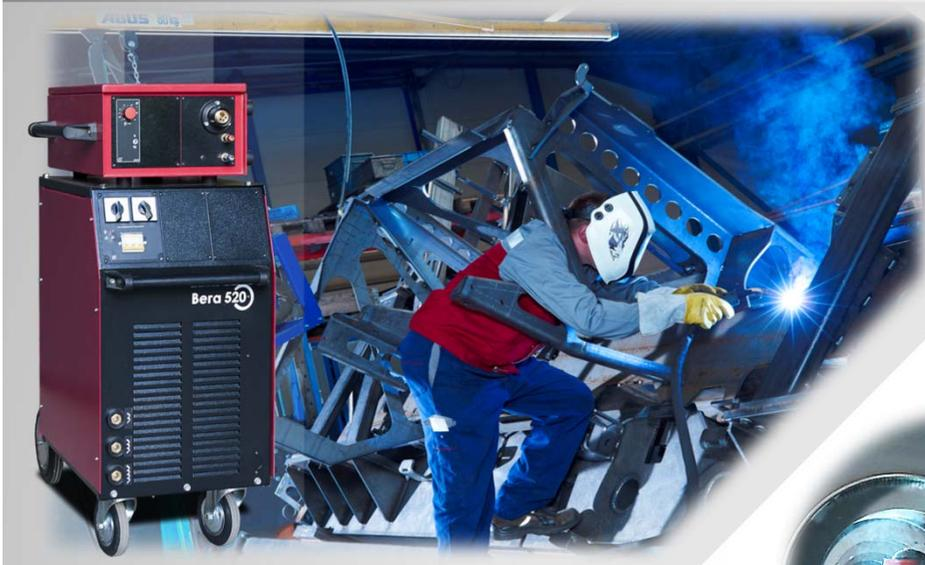
Аппарат стандартной сварки плавящимся электродом в среде защитных газов (MIG/MAG) со ступенчатым переключением напряжения
