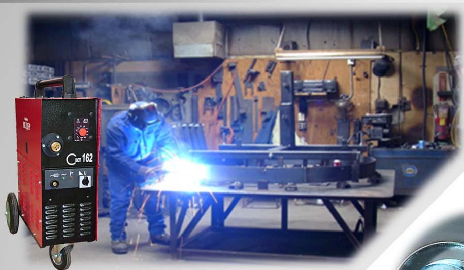
Аппарат стандартной сварки плавящимся электродом в среде защитных газов (MIG/MAG) со ступенчатым переключением напряжения
