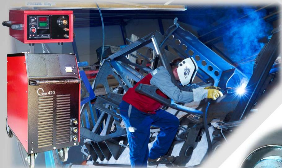
Аппарат стандартной сварки плавящимся электродом в среде защитных газов (MIG/MAG) с плавной регулировкой напряжения
