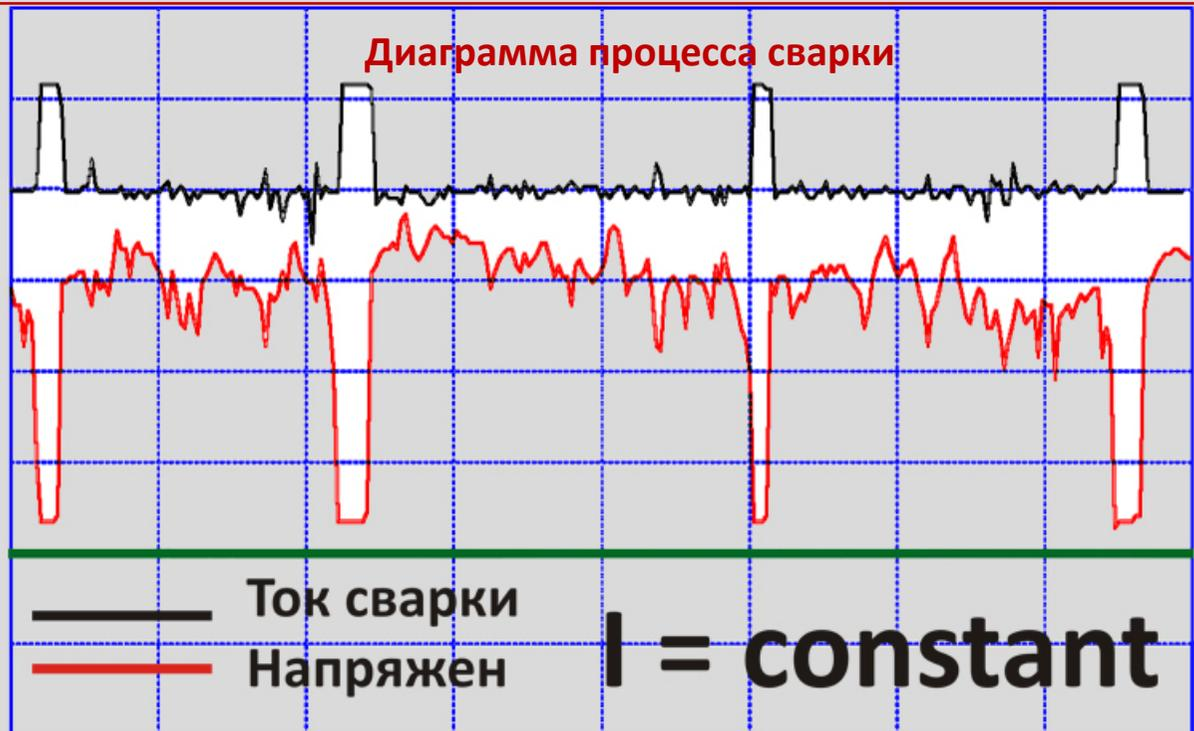
Параметры сварки: ток сварки 102 А; напряжение 22,2 В;
