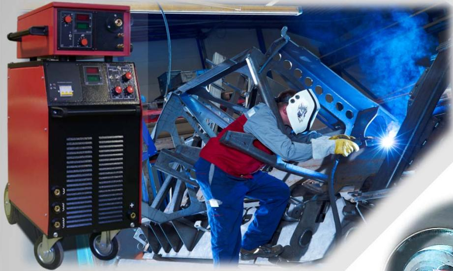
Универсальный аппарат для стандартной сварки плавящимся электродом в среде защитных газов (MIG/MAG) с плавной регулировкой напряжения, для сварки самозащитной порошковой проволокой, сварки MMA и TIG постоянным током
