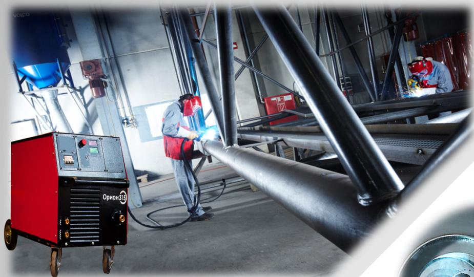
Аппарат стандартной сварки плавящимся электродом в среде защитных газов (MIG/MAG) с плавной регулировкой напряжения
